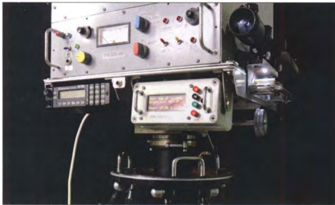
Bild 1: Prototyp der digitalen Richtungsanzeige unterhalb des Drehtischs mit der Übertragungstechnik Fotos: DK1ZD
