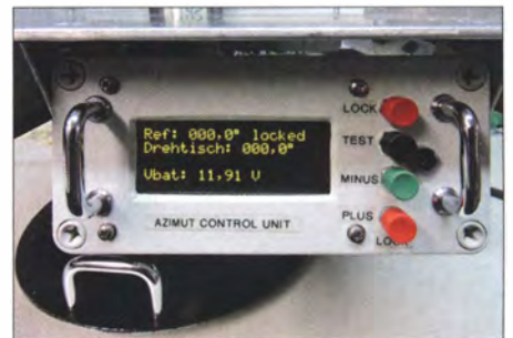
Bild 2: Das gut ablesbare OLED-Display und die vier Bedientasten der Richtungsanzeige gewährleisten die einfache Handhabung des Geräts in der Praxis.
