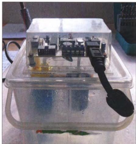
Bild 1: Pumpensteuerung (oben) auf dem Sammelbehälter für Kondenswasser (unten)
