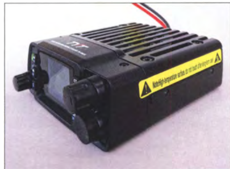
Der Lautsprecher strahlt nach oben ab. Der Druckguss-Kühlkörper wird von einem Lüfter unterstützt.
