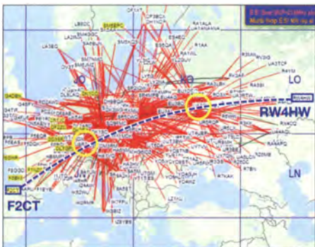
Eine Momentaufnahme der 2-m-QSOs am 16.6.; deutlich sind mehrere Reflexionsgebiete zu erkennen – auch diejenigen des QSOs F2CT-RW4HW. (Grafik: www.dxmaps.com ; nachträglich markiert)
