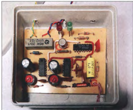
Bild 1: Die kleine Leiterplatte des Zeitrelais lässt sich zum Beispiel in einer Feuchtraumabzweigdose unterbringen. Foto: DM3SPE
