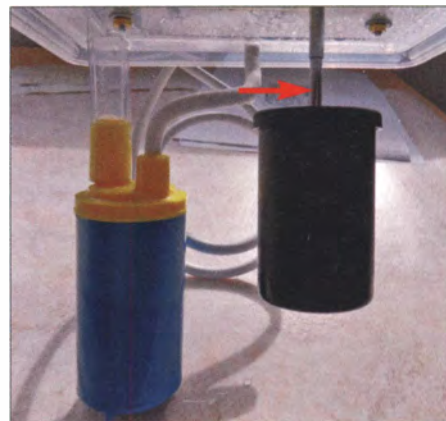
Bild 9: Tauchpumpe und der am dünnen Antennensegment befestigte Schwimmer
